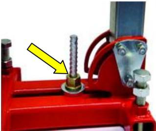
Прорезь в основании платформы предназначена для крепления станины с помощью анкерного болта (опция) к поверхности сверления. Этот способ крепления занимает много времени, поскольку требует установки анкерного дюбеля перед каждым алмазным сверлением. Вместе с тем это самый надежный способ крепления станины.
