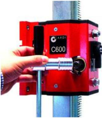
Рукоятка для перемещения каретки устанавливается на вал привода каретки.
