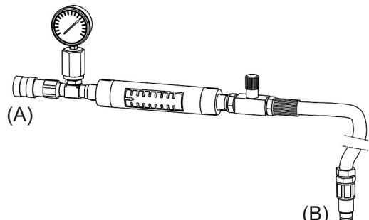
Для регулировки или проверки подачи гидравлического масла и уставки предохранительного клапана рекомендуем использовать испытательное оборудование Atlas Сорсо или его аналоги.
