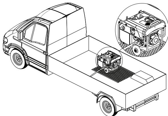
Перед транспортировкой необходимо обеспечить надежную фиксацию агрегата. Агрегат следует перевозить в вертикальном положении. Для его подъема следует использовать утвержденное подъемное оборудование.
