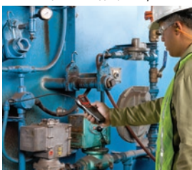
Используйте micro CD-100 для обнаружения газов при выполнении работ по эксплуатационному содержанию оборудования и зданий
