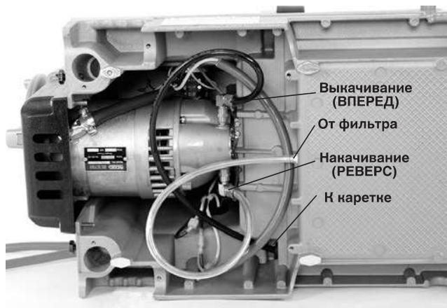
Рис. 25В – Подключения масляного насоса для нарезания правой резьбы (переключатель в положении ВПЕРЕД)
