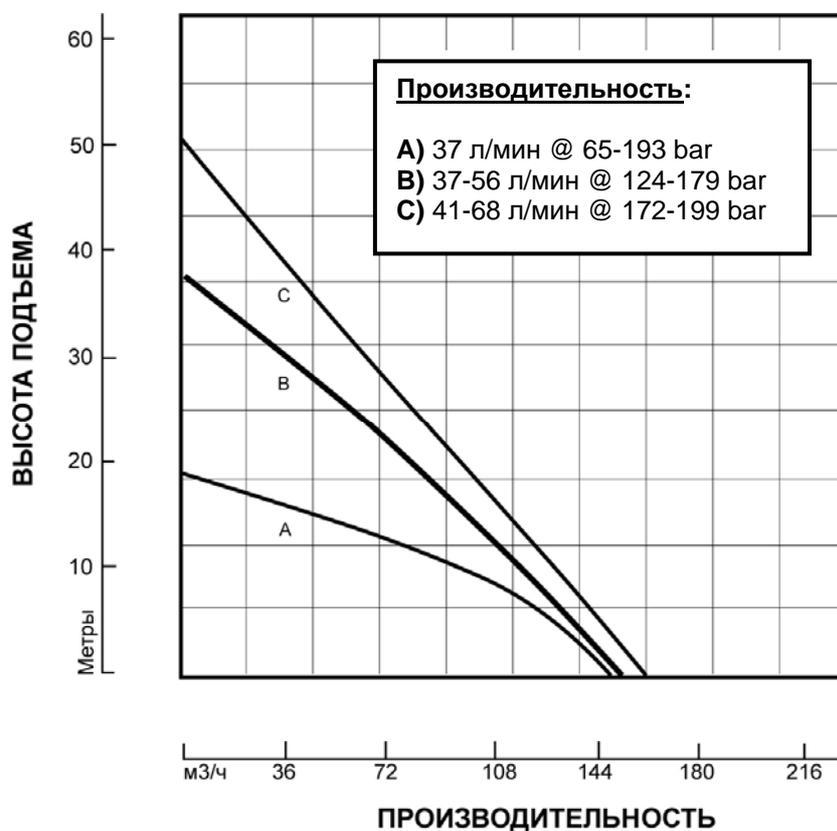
Графики основываются на испытаниях. Перекачиваемая среда - воды, температура – 15,5 С
