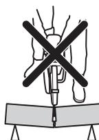
Если диск зажат или застрял в зоне отдачи, сила реакции будет толкать устройство вверх и назад к оператору вращательным движением, что может вызвать опасную или даже смертельную травму. Следите за возможными перемещениями распиливаемого элемента. Если распиливаемая деталь неправильно закреплена и смещается при резке, может произойти заклинивание режущего диска и возникнуть отдача.
