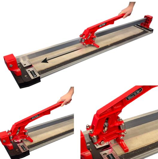
5.3 Поднимите ручку и убедитесь, что прижимная пластина находится на плитке в начале, увеличьте давление на ручку, пока плитка не будет разломана на две части. Не применяйте чрезмерное давление, это может привести к поломке.
