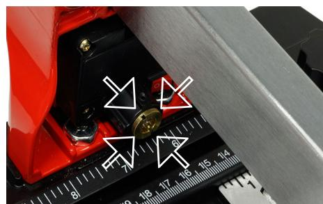
4.2 С помощью болтов на боковом кронштейне регулируется прямолинейность реза. Ослабьте гайки с двух сторон, выставьте направляющую в нужном положении и зафиксируйте.
