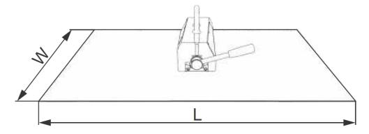
Грузоподъёмный магнит крепится к центру тяжести заготовки. Максимальные параметры груза W и L смотри в пункте 2.6.
