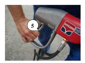
**5.** Прижмите пусковой рычаг ⑤, к рукоятке. Встаньте устойчиво, настройте переднюю рукоятку и зафиксируйте ее. Держите рукоятку в зафиксированном состоянии во время бурения.
