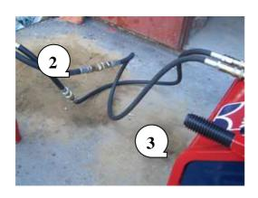
**2.** Подключите переходные рукава высокого давления ② к удлинительным рукавам ③ предварительно очистив быстроразъемные соединения. Подключите подачу воды.
