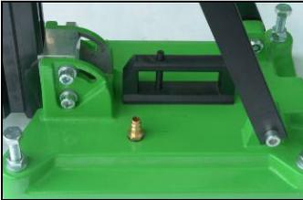
Verbinden Sie den Bohrständer und die Vakuumpumpe mit Hilfe des Vakuumschlauchs.
