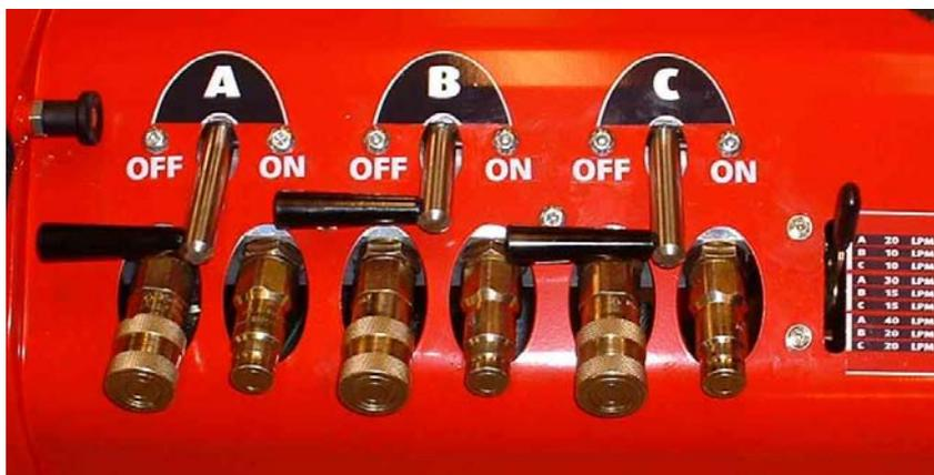
1. По средством поворота рукоятки регулировки потока гидравлической жидкости вправо выставите необходимый поток в соответствии с нанесенным цифровым значением. Установки перепускного клапана сброса давления одинаковы для любого потока.
