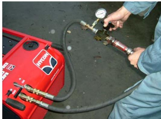
2. Для измерения потока: запустите гидравлический источник питания и снимите показания со шкалы объемного расходомера
