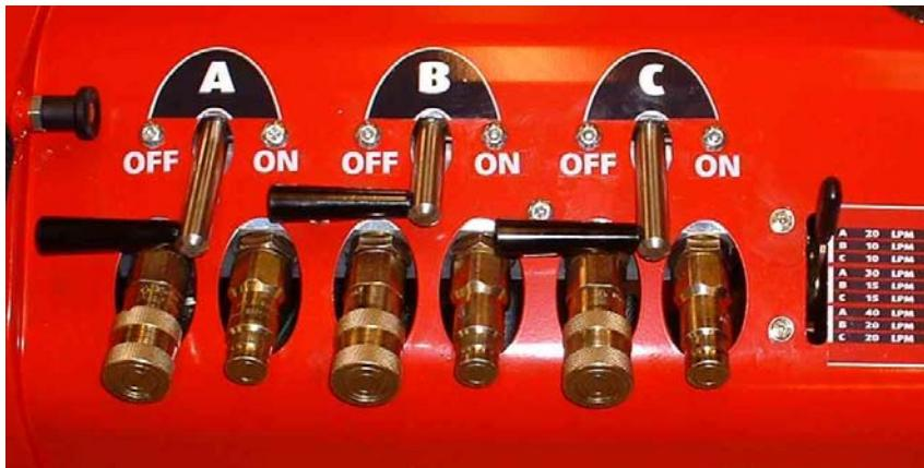
1. По средству поворота рукоятки регулировки потока гидравлической жидкости вправо выставите необходимый поток в соответствие с нанесенным цифровым значением.
