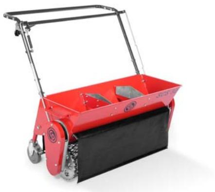
**Тележка для распределения топинга SCS 32** равномерно распределяет все типы износостойкого материала, вдавливая его в верхний слой бетонного пола и формируя поверхность с повышенной износостойкостью. Вместо колёс на модели SCS 32 используется уникальный распределяющий барабан, который под воздействием веса тележки вдавливает топпинг в бетон.
