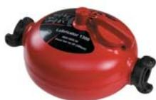
Для пневматического оборудования без встроенной системы смазки требуется отдельный лубрикатор, который обеспечит сохранение слоя масла на всех подвижных частях. Подача смазки осуществляется независимо от положения лубрикатора благодаря особой форме маслозаборника. Многие дешёвые лубрикаторы других марок не могут функционировать в перевёрнутом состоянии.
