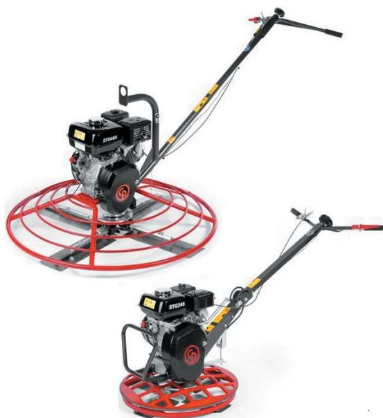
**Бетонозатирочные машины STG** предназначены для затирания свежего бетона после вибрационной подготовки и разравнивания с помощью виброрейки. Модель STG 245 прекрасно подходит для отделки краёв и небольших бетонных плит, тогда как машины STG 365 и STG 465 предназначены для плит большей площади.
