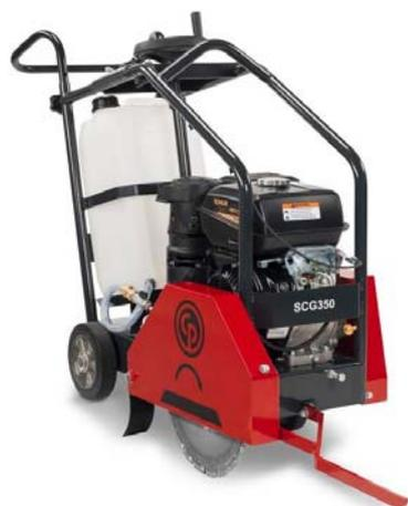
**Нарезчики швов SCG** позволяют разрезать бетон, асфальт, железобетон. При использовании алмазных дисков диаметром 450 мм, делают пропил на глубину 175мм. Бак, объемом 30, подает воду на обе стороны диска, что равномерно охлаждает диск и увеличивает его ресурс.
