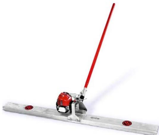
**Ручная виброрейка CP LBG 804** применяется для обработки небольших площадей заливки. Ручка удлиняется до 4,5 метров, что позволяет обрабатывать карты шириной до 4-х метров. Специальная форма профиля позволяет плавно разравнивать бетон, не оставляя волн и передавать вибрацию бетону без потерь по всей длине профиля.
