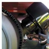
**Префильтр.** Дополнительная ступень фильтрации поступающего в винтовую пару воздуха. Опция востребована при работе в особо запыленных условиях (например, пескоструйные работы).
