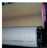
**Воздушный фильтр с дополнительным картриджом.** Картридж безопасности устанавливается вместе с основным воздушным фильтром и увеличивает фильтрацию входящего воздуха, что уменьшает возможность попадания пыли в двигатель.
