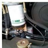
**Дополнительный топливный фильтр с влагосепаратором.** Предназначен для удаления воды и твердых частиц из топлива. Ощутимо продлевает ресурс топливной системы двигателя при использовании топлива низкого качества.
