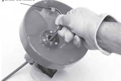
Figura 9 – Instalarea capătului cablului în suport
