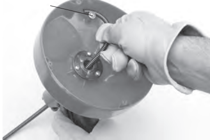
Рис. 9 – Установка конца спирали в держатель
