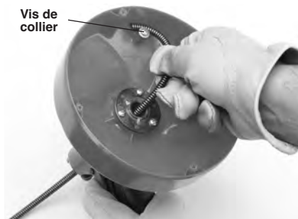
Figure 9 – Engagement du câble dans la bride
