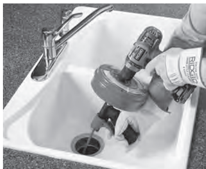
Рис. 8А – Использование Power-Spin с помощью аккумуляторной дрели
