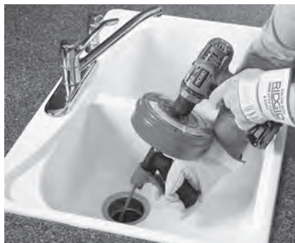
Figur 8A – Använda Power-Spin med en batteridrivna bormaskin
