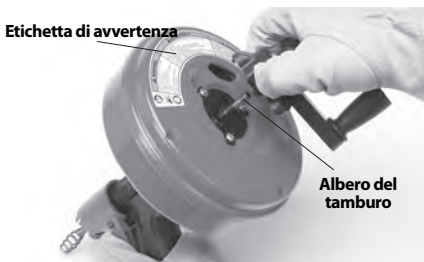
Figura 2 – Rimozione dell'impugnatura della manovella dal Power-Spin
