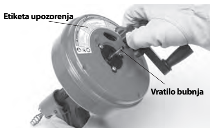
Slika 2 – Uklanjanje ručice za obrtanje sa Power-Spin-a
