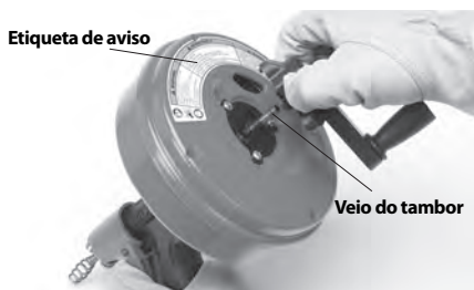
Figura 2 – Remover a pega da manivela da Power-Spin
