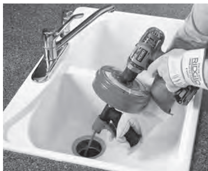
Figura 8A – Power-Spin acționat de sfredelul cu baterie
