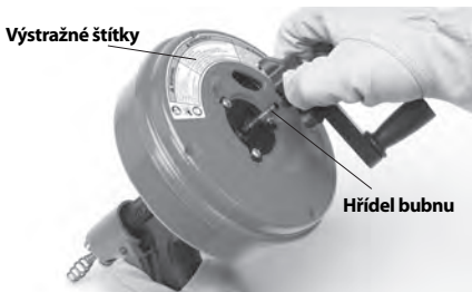
Obrázek 2 – Odstranění držadla kliky z přístroje Power-Spin
