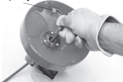
Figur 9 – Montering af spiralenden i holderen
