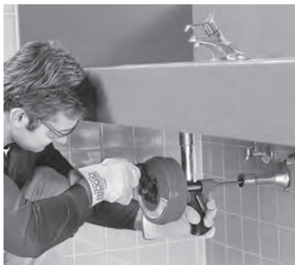
8. ábra – A Power-Spin használata kézzel
