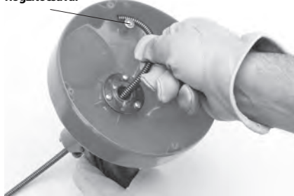
9. ábra – A kábelvég beszerelése a tartóba
