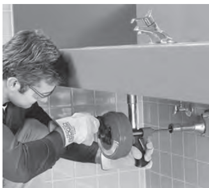
Figura 8 – Power-Spin usato a mano
