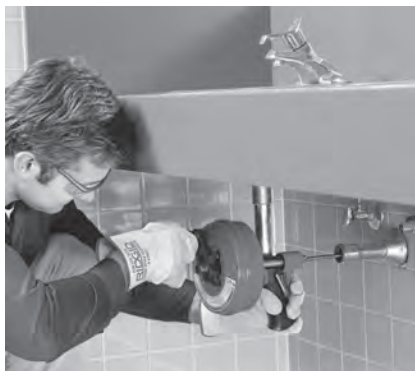
Obrázek 8 – Power-Spin používaný ručně
