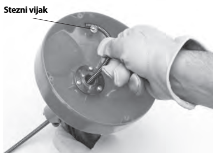
Slika 9 - Ugradnja kraja sajle u držač
