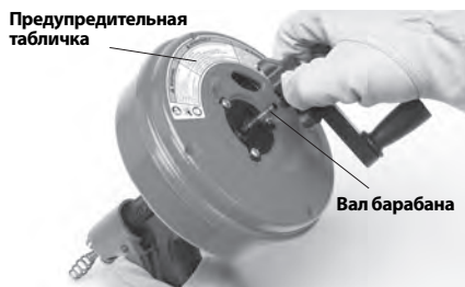
Рис. 2 – Снятие рукоятки с Power-Spin
