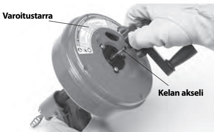
Kuva 2 – Kahvan irrotus Power-Spin-laitteesta
