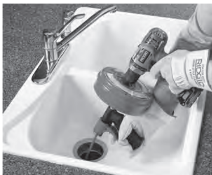
Figur 8A – Power-Spin drevet av batteridrill
