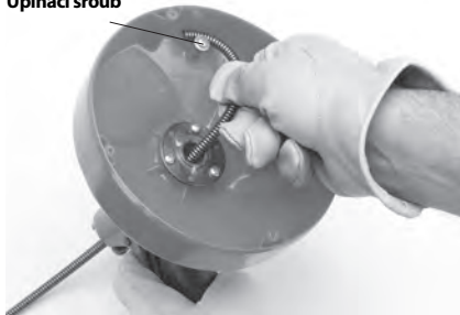
Obrázek 9 – Instalace konce kabelu do držáku
