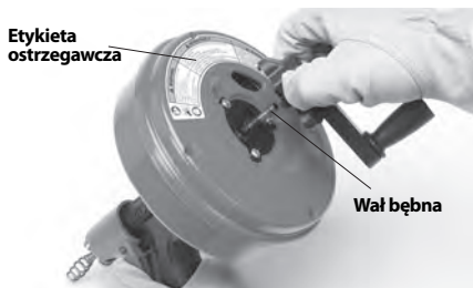
Rysunek 2 – Zdejmowanie korby z narzędzia Power-Spin
