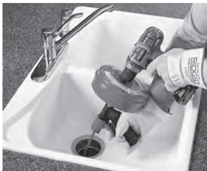
Obrázek 8A – Power-Spin poháněný bateriovou vrtačkou
