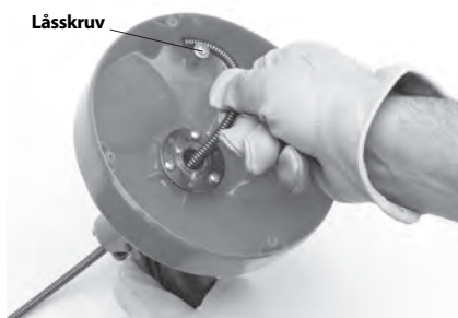
Figur 9 – Spiraländan monteras i hållaren
