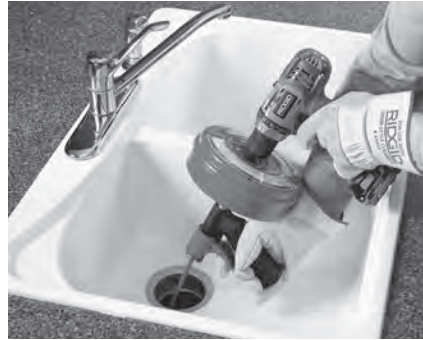
Şekil 8A - Bataryalı Matkap ile Çalıştırılan Power-Spin
