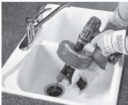
Figura 8A – Power-Spin alimentato con Trapano a batteria
