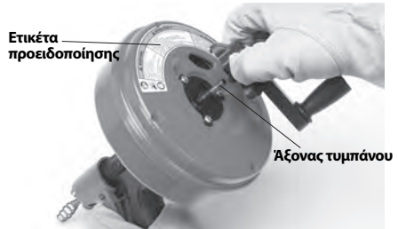
Εικόνα 2 – Αφαίρεση της λαβής του χειροστρόφαλου από το Power-Spin
