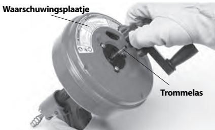
Figuur 2 – De zwengel van de Power-Spin verwijderen
