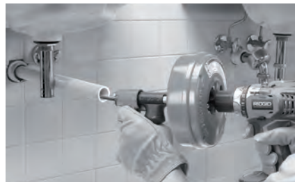
7. ábra – Példa lefolyótoldatra a dobtól számított 4" (100 mm-ig)
