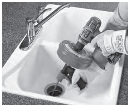
Slika 8A – Power-Spin pogonjen aku bušilicom
