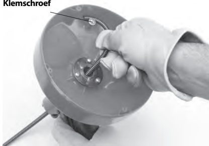
Figuur 9 – Veeruiteinde in de houder bevestigen
