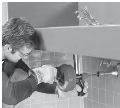
Figura 8 – Power-Spin utilizada manualmente
