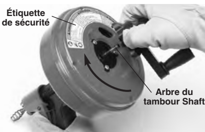
Figure 2 – Retrait de la manivelle du Power-Spin
