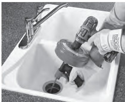
Rysunek 8A – Przepychacz Power-Spin napędzany wkrętarką akumulatorową
