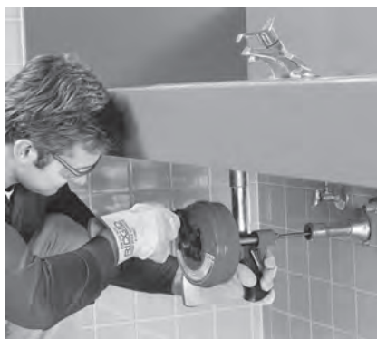
Figura 8 – Power-Spin utilizat manual
