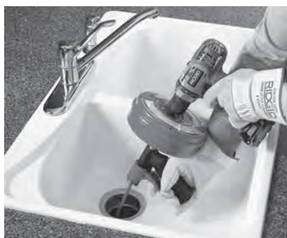
Figur 8A – Power-Spin drevet af en batteridrevet boremaskine
