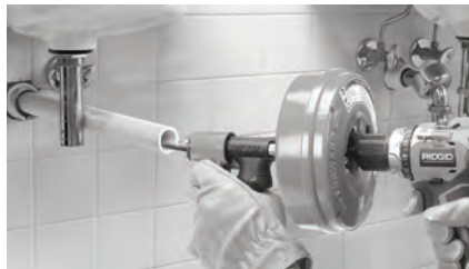
Figura 7 – Forma en que se prolonga la entrada al desagüe para que la nariz del desatascador quede a menos de 4 pulg. (100 mm) del acceso
