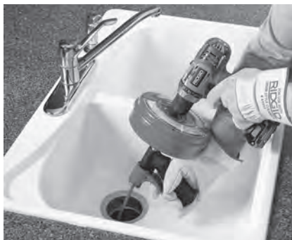
Slika 8A – Uporaba naprave Power-Spin z baterijskim vrtnikom
