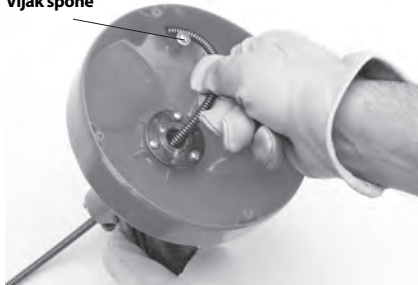
Slika 9 – Namestitev konca kabla v držalo
