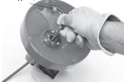
Εικόνα 9 – Τοποθέτηση απόληξης του σπирάλ μέσα στη διάταξη συγκράτησης
