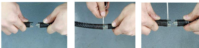
Рис.3 Соединение и отсоединение инструмента
