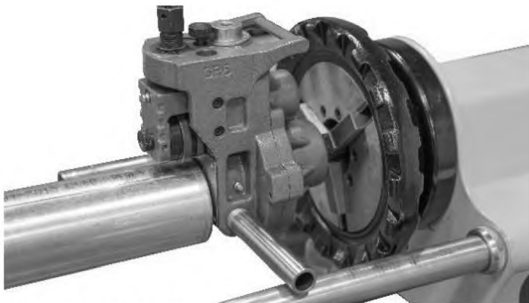
Рис 3 - Монтаж желобонакатного станка GR6 на силовой привод SQ50D
