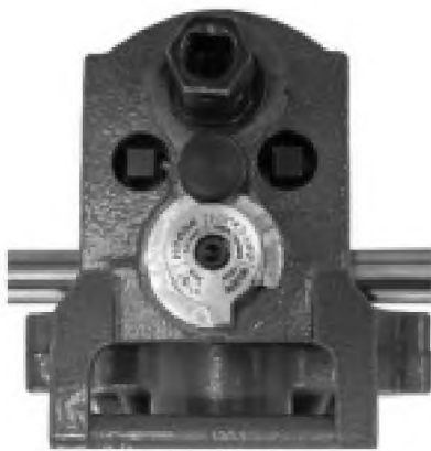
Рис 7А. Параметр правильной глубины канавки расположен непосредственно под регулировочной гайки
