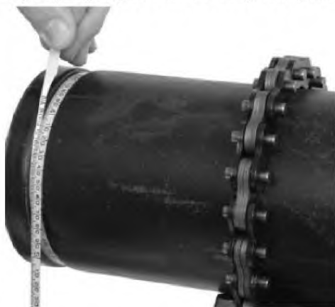
Рисунок 8 — Измерение диаметра желобка с помощью кронциркуля
