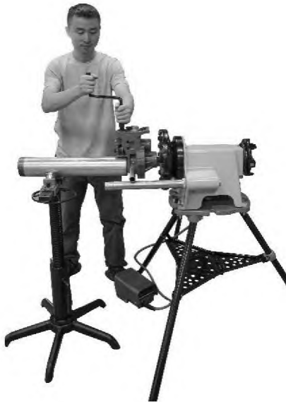
Рисунок 9 - Рабочее положение во время прокатки канавок
