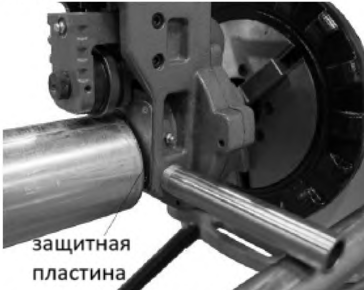
Рисунок 5- Предотвращение контакта трубы с приводным валом и защитным кожухом
