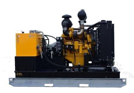
Эта гидравлическая станция мощностью 400 лошадиных сил оснащена дизельным двигателем John Deere, гидравлическим насосом с компенсацией давления, гидравлическим масляным радиатором и встроенным топливным баком. Она предназначена для питания больших погружных насосов, таких как \$30М и другое гидравлическое оборудование, требующее потоков до 568 л/мин и давления до 272 бар.
