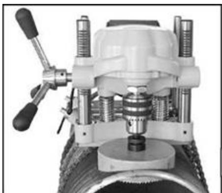
стенок трубы и размера отверстия, может потребоваться несколько раз слегка вытянуть сверло для удаления стружки. По необходимости станок может быть выключен и потребуется небольшое количество смазочного масла для смазки обрабатываемой детали.
