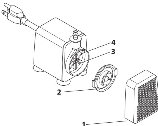
Для удаления металлических частиц с магнита ротора можно использовать тряпку.
