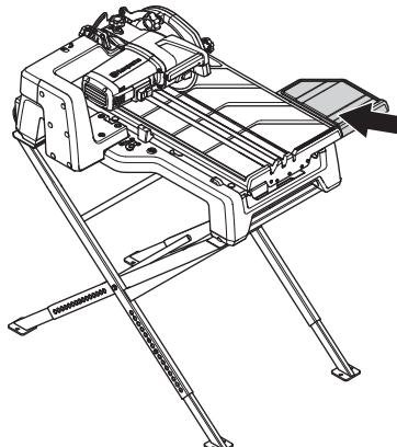
Если боковой стол не находится на уровне отрезного стола, выполните регулировку. Выполните регулировку с помощью винтов.
