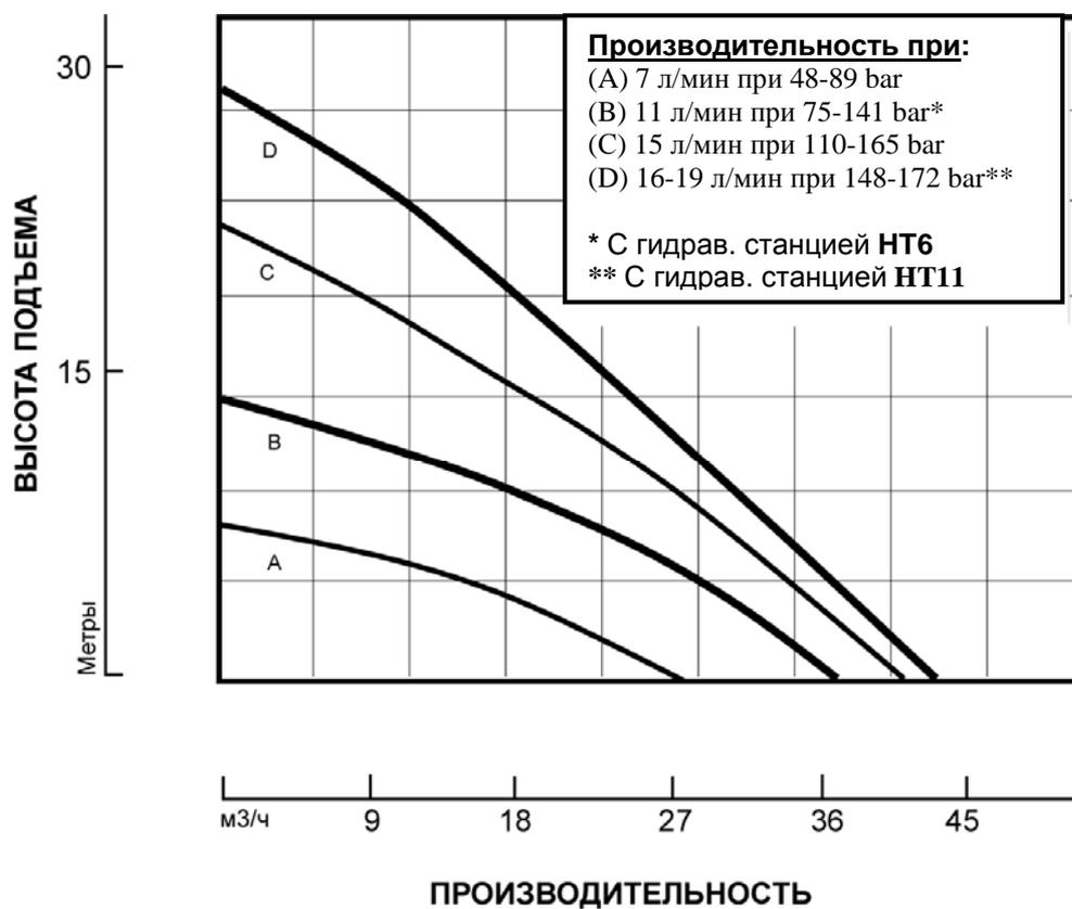
Графики основываются на испытаниях. Перекачиваемая среда - воды, температура - 15,5 С
