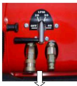
Требуемый поток может быть установлен на панели станции. Маркировка выгравирована.
