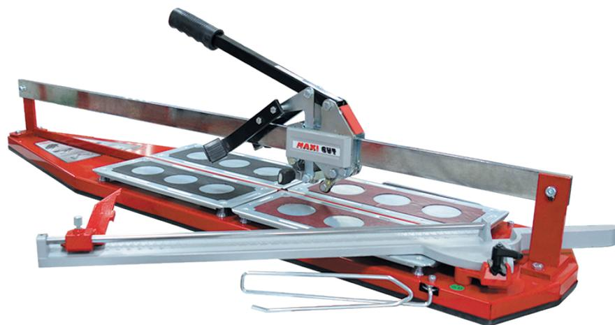
**KRISTAL MAXI-CUT** - это классический монорельсовый плиткорез для профессионального использования, который заслужил высокую оценку в мире мастеров плиточников. Ручной плиткорез подходит не только для резки всех типов плитки толщиной от 3 до 23 мм, но и для резки стеклянной мозаики. Произведен специально для ГК «DIAM».
