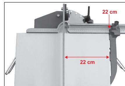
**Регулировка на 45°.** Установите линейку в положение 45° и зафиксируйте ее. Отрегулируйте размер, который вы хотите резать с помощью упора на линейке и считывайте размер по верхней шкале.
