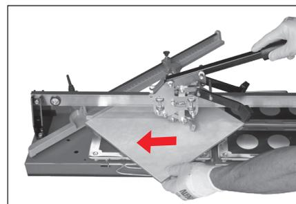
**Разлом.** Слегка нажмите на рычаг вниз для разлома плитки.
