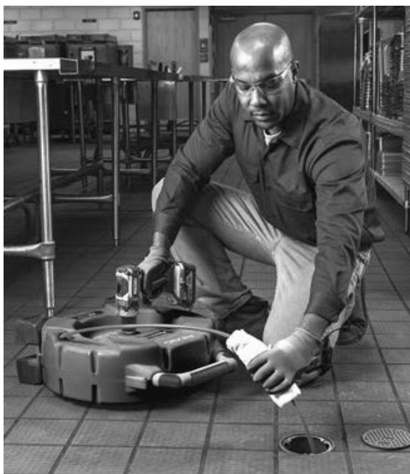
Рис. 10 - Нанесение смазки на оболочку троса
