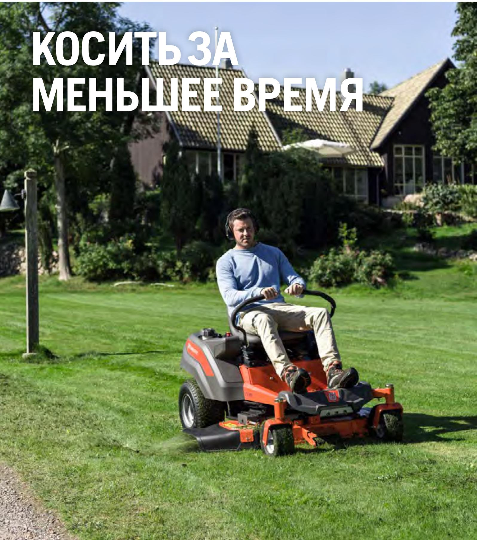
Где бы Вы ни использовали газонокосилки Husqvarna с нулевым радиусом разворота – при коммерческом, либо частном использовании, – они позволят Вам выполнить работу быстро и эффективно. Благодаря нулевому радиусу разворота нескошенная область в конце прохода, когда Вы поворачиваетесь на 180°, чтобы начать новый проход, отсутствует. Мы разработали превосходные функции для повышения эргономичности и комфорта, чтобы оператор мог сосредоточиться на получении лучших результатов кошения.
