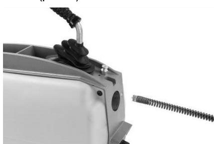
Рисунок 2 - Установка троса в переднюю часть машины
