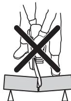
Если цепь зажата или застряла в зоне отдачи, сила реакции будет толкать резчик вверх и назад к оператору вращательным движением, что может стать причиной серьезных или даже смертельных травм. Следите за возможными перемещениями распиливаемого элемента. Будьте внимательны, если заготовка несколько передвинулась или произошло что-либо другое, что заставило бы разрез соединиться и зажать режущее оборудование.
