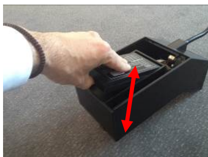
Рис.13: Удаление и вставка аккумулятора
