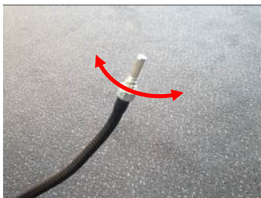
Рис. 20: Откручивания и прикручивание фильтра частиц
