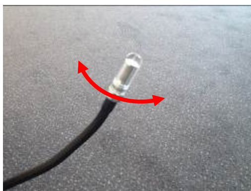
Рис. 19: Отвинчивание и закручивание прозрачной крышки.
