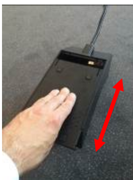
Рис. 12: Открытие и закрытие отделения аккумулятора
