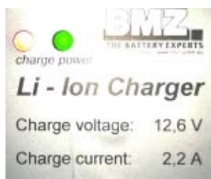
Рис. 18: Горящий зеленый „Power“ ("Питание") и красный "Charge" ("Зарядка") индикаторы показывают, что питание включено и аккумулятор заряжен
