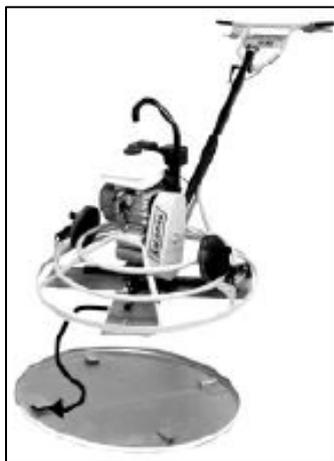
1. Установите затирочную машину на затирочный диск.
