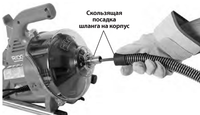
Рис. 4 – Поддача троса в направляющий шланг
