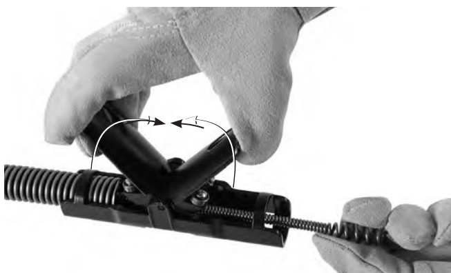
Рис. 5 – Поддача троса сквозь узел AUTOFEED®
