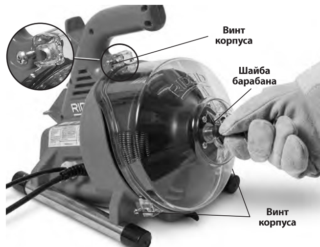
Рис. 13 – Открывание прочистной машины
