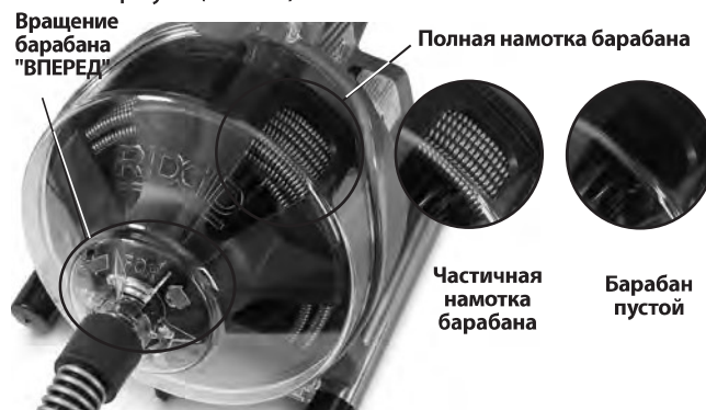
Рис. 10 – Контроль троса в барабане
