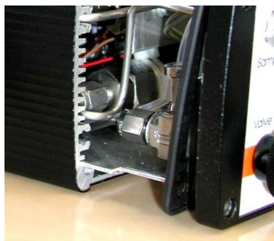
Рисунок 6: Вставьте алюминиевую пластину в самый нижний паз при сборке
