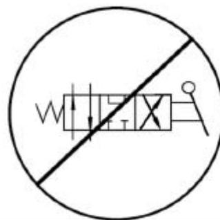
**Не подключать к гидравлическим системам с закрытым центром**
