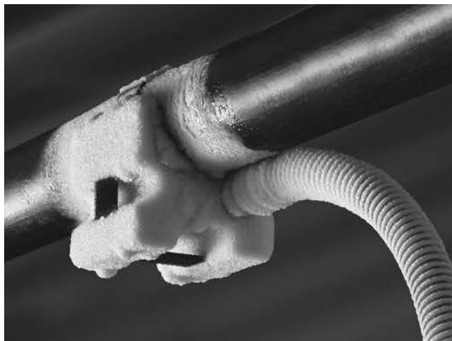
9-сурет – Мұздату басы құбырға қатырылған
