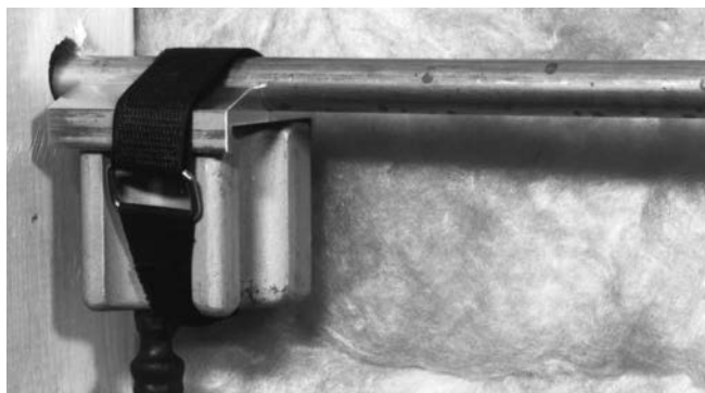
Slika 7 – Zamrzovalna glava s končnim adapterjem pritrjena s trakom za zapenjanje z ježkom
