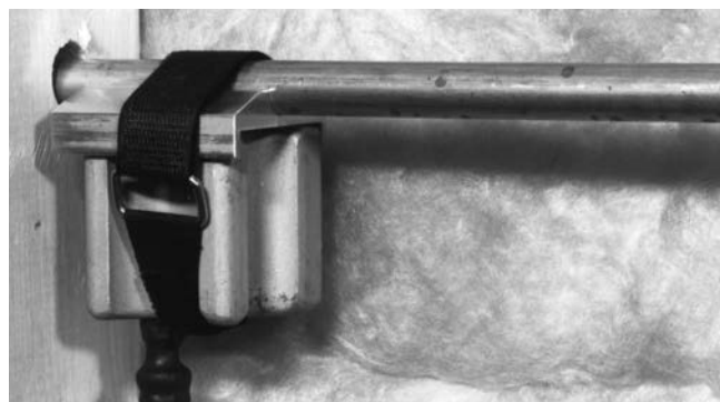
7. ábra – Fagyasztófej a különböző adapterekkel
