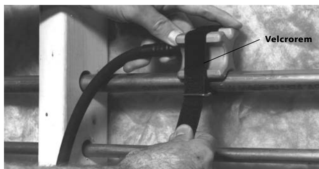
Figur 5 – Fastgørelse af frysehoved med velcrorem
