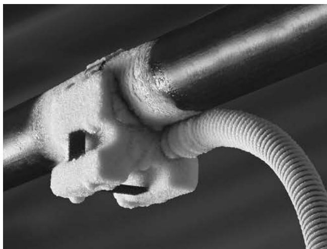
Slika 9 – Zaleđena glava za zamrzavanje na cevi
