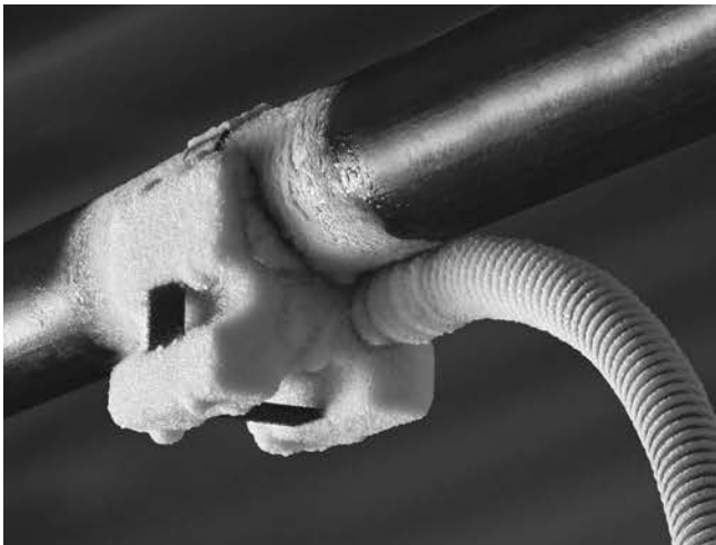
Figura 9 – Testa di congelamento congelata sul tubo
