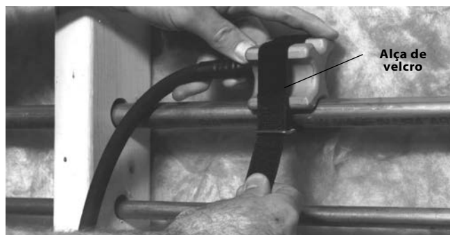
Figura 5 – Aplicar cabeça de congelação com alça de velcro
