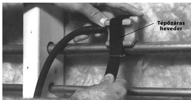
5. ábra – Fagyasztófej a tépőzáras hevederrel
