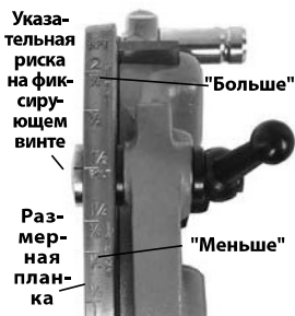
Рис. 11 – Настройка размера резьбы
