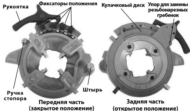
Рис. 13 – Полуавтоматическая резьбонарезная головка
