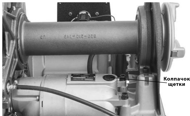
Рис. 34 – Снятие крышки электродвигателя/ замена щеток
